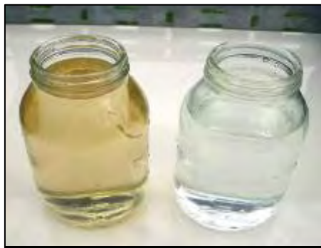
反冲洗水 过滤水
