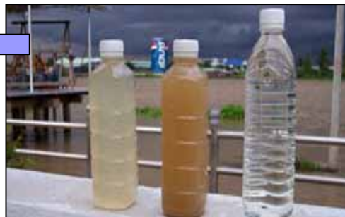
未过滤水 反冲洗 过滤水
