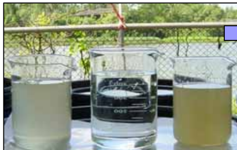
未过滤水 过滤水 反冲洗
